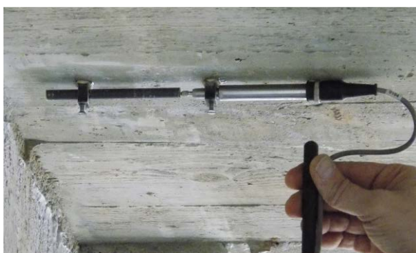
Slika 4: Položaj dilatometra u blizini oslonca (kruti ugao rama)
