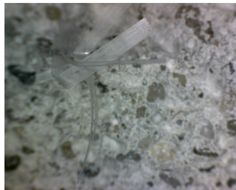
Slika 8 – Površina maltera F18 na mestu loma nakon ispitivanja čvrstoće pri savijanju
