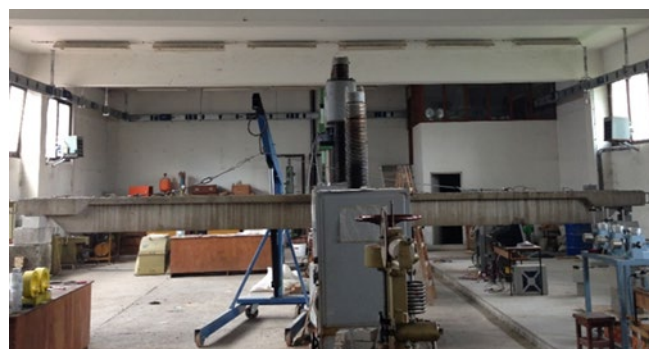
Slika 3 - Ispitivanje greda opterećenih koncentrisanom silom
