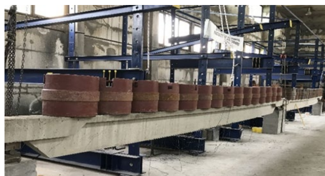
Slika 4 - Ispitivanje greda pod dejstvom ravnomjernog opterećenja
