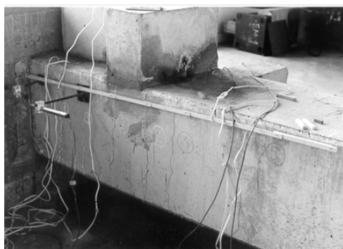
Slika 13 – Model EM-6: Prikaz propagacije pukotina u modelu
