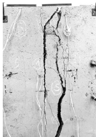
Slika 9 – Model EM-3: Velike deformacije veze na mestu oslanjanja (levo); Model EM-4: Velike pukotine u ploči za kontinuitet.
