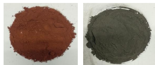
Slika 1. Korišćeni vezivni materijali: elektrofilterski pepeo (levo), crveni mulj (desno)
