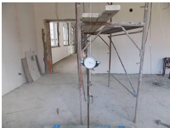
Slika 5 – Ugibomer sat sa žicom (U3)
