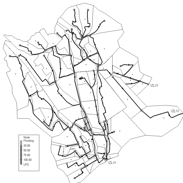
Slika 4 – Plavljenje u čvorovima u 9:30 (najveće količine atmosferskih otpadnih voda)
