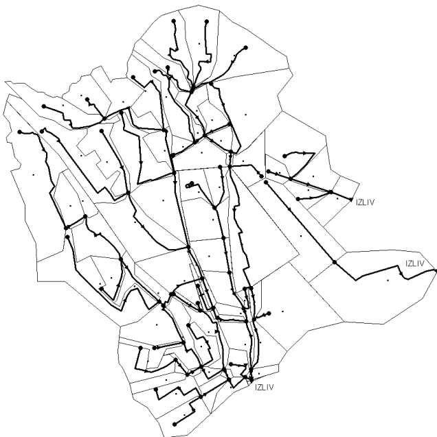
Slika 1 – Skeletizovana kanalizaciona mreža grada Vranja
