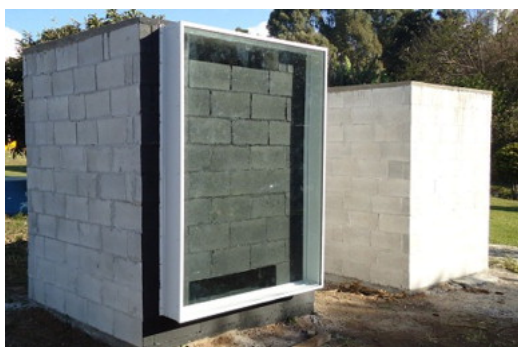
Slika 7 - Procena efikasnosti Trombovog zida u suptropskoj klimi
