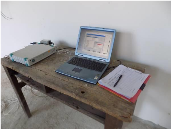
Slika 6 – Merna stanica (akvizicijski sistem SPIDER 8 povezan na PC)
