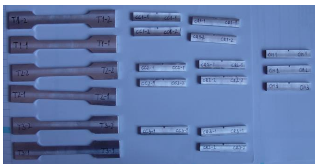
Slika 10 – Epruveta za ispitivanje zavarenih spojeva na zatezanje i testom za ispitivanje udarne žilavosti po Šarpiju
