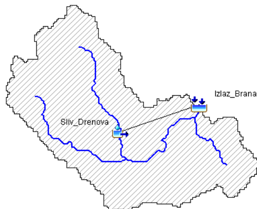
Slika 4: Model sliva u HEC-HMSu.
