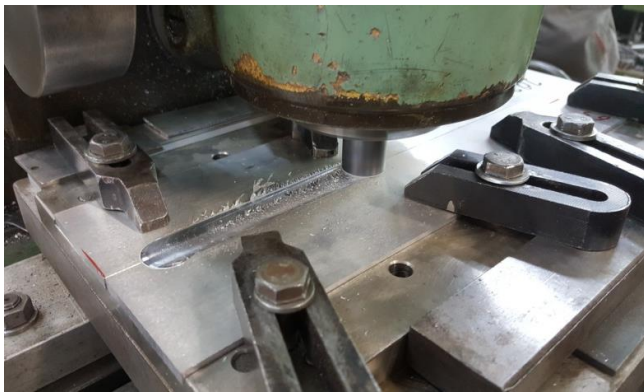
Slika 5 – Primena alatne mašine – glodalice za zavarivanje ploča postupkom trenjem sa mešanjem
