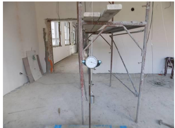
Slika 5 – Ugibomer sat sa žicom (U3)
