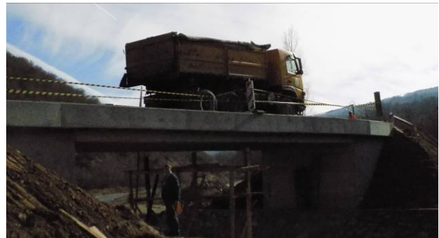
Slika 18: I faza opterećenja (simetrija-centralno)
