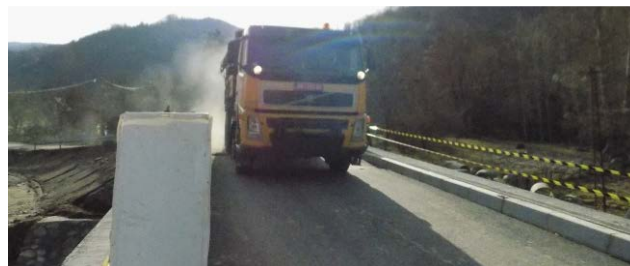
Slika 5: III faza dinamičkog opterećenja (prelaz preko prepreke maksimalnom brzinom)
