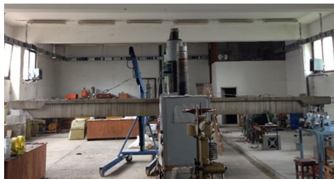
Slika 3 - Ispitivanje greda opterećenih koncentrisanom silom
