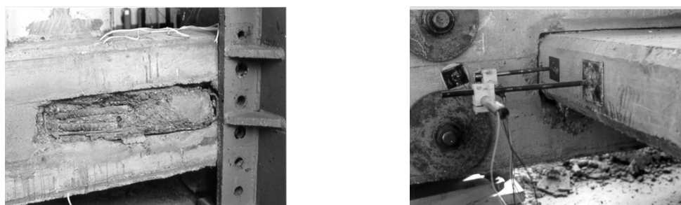
Slika 7 – Lom veze grednog nosača sa stubom: Model EM-1 (levo); Model EM-2 (desno).
