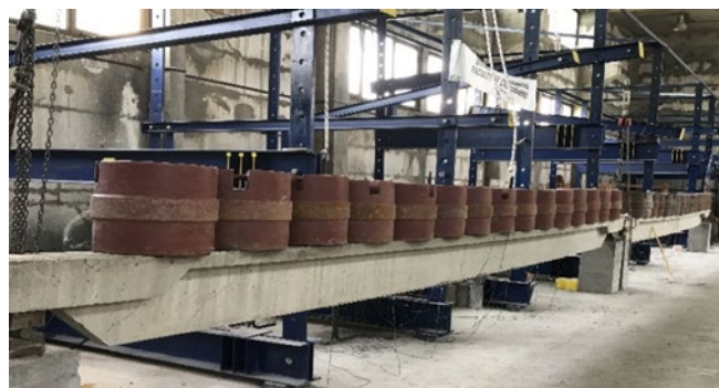
Slika 4 - Ispitivanje greda pod dejstvom ravnomjernog opterećenja
